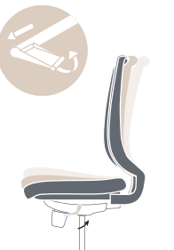
Leva a sinistra per bloccare l'inclinazione della seduta in 4 posizioni
